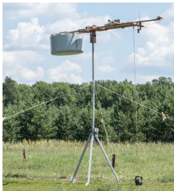
Рис. 3. Макет антенной системы на приспособлении при угле наклона 0^\circ
